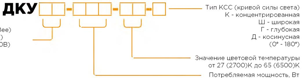
При взрывозащищенном исполнении в название модификации добавляются буквы "Ex", следующим образом: Ex-ДКУ 01-130-50-Д120.
